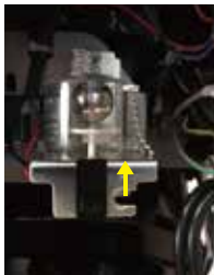
感震装置リセットレバー 解除方法:レバーを上を持ち上げます。
